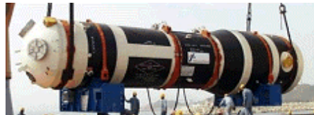
Générateur de vapeur
